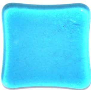
1 Schicht, insgesamt 3 mm Das Glas hat sich nach innen verzogen
